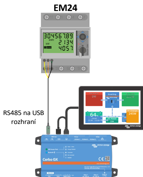
Kabelové připojení EM24 k Cerbo GX pomocí rozhraní RS485 na USB
